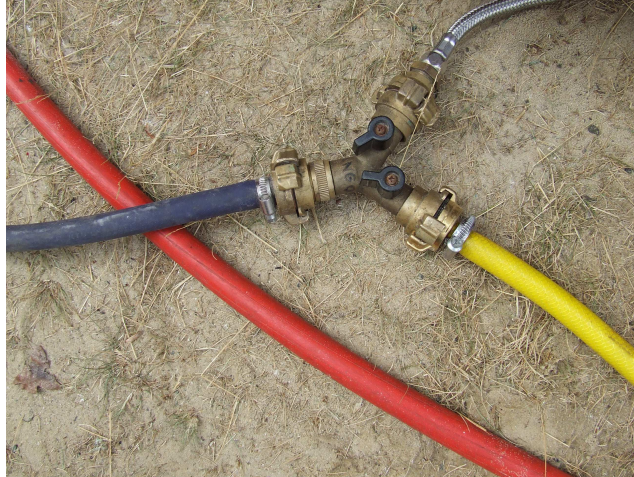
Bild 3: Ungeschützt auf dem Boden liegende Schlauchkupplung (drohender Keimeintritt).
