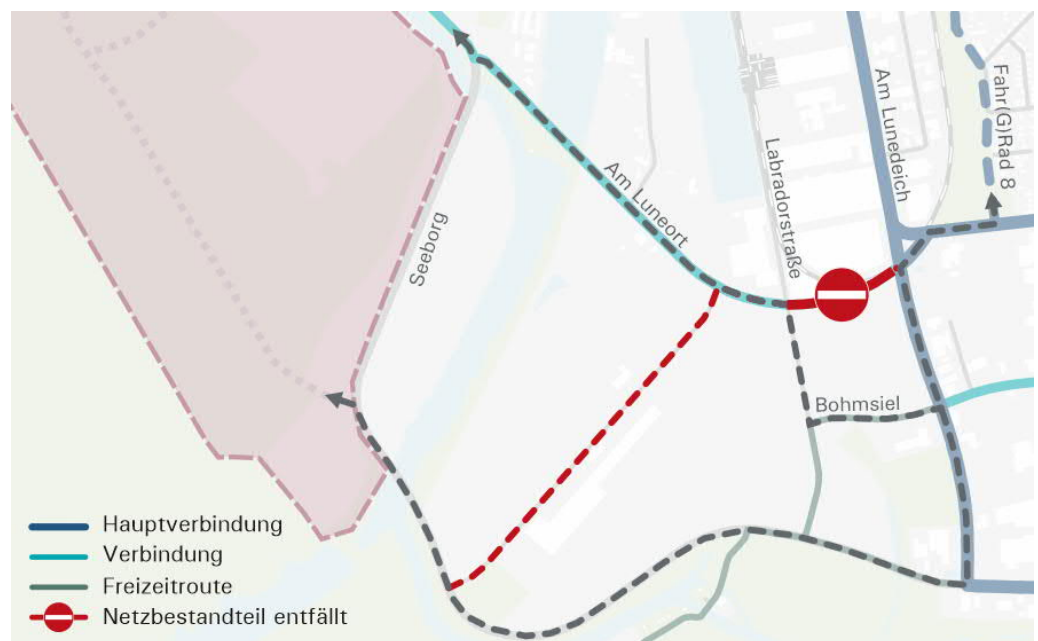
Abb. 18 Umfahrung Straßenabschnitt Am Lunedeich
