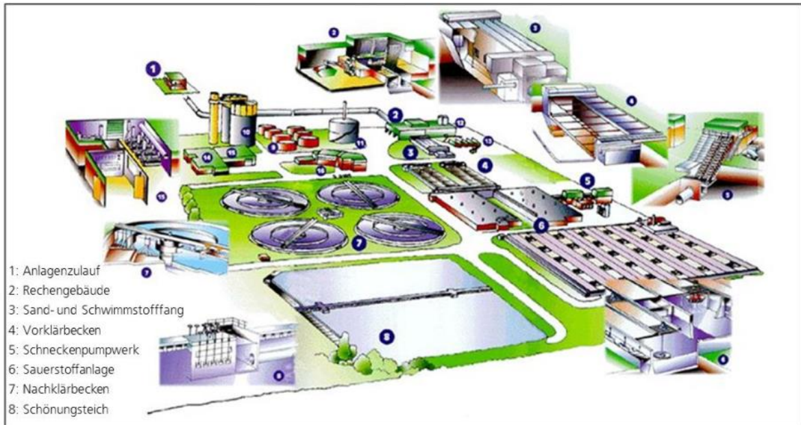
Abbildung 7: Schema der Zentralkläranlage Bremerhaven. (Quelle: BEG ZKA 2018)
