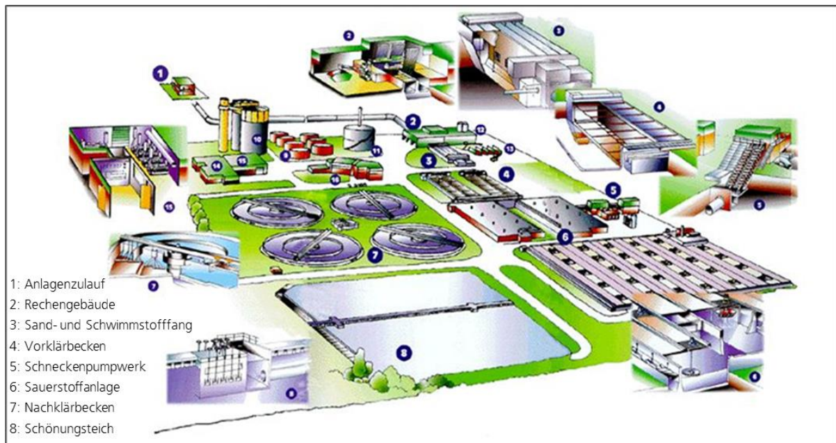
Abbildung 4-15: Schema der Zentralkläranlage Bremerhaven
