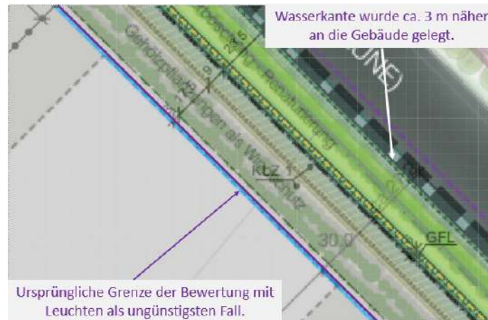
Abbildung 3-16 - Gegenüberstellung am Beispiel einer GE 3 mit Grenze der ursprünglichen Bewertung und der Wasserkante
