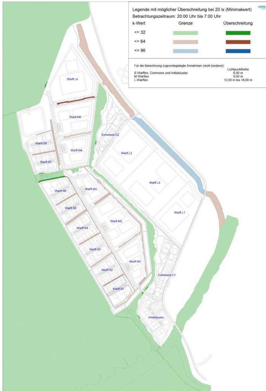
Abbildung 8-4 - adaptiert vom städtebaulichen Entwurf der Ingenieurgesellschaft (2020) mit Darstellung der Überschreitung der Grenzwerte der Blendwirkung für den Zeitraum 20:00 Uhr bis 7:00 Uhr und einer mittleren Beleuchtungsstärke auf den Warften, Commons sowie dem Initialcluster von 20 lx für Leuchten mit hoher Entblendung (-> Minimalwerte)
