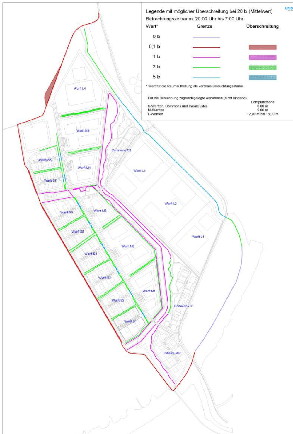
Abbildung 14-16 - adaptiert vom städtebaulichen Entwurf der Ingenieurgesellschaft (2020) mit Darstellung der Überschreitung der Grenzwerte der Raumaufhellung für den Zeitraum 20:00 Uhr bis 7:00 Uhr und einer mittleren Beleuchtungsstärke auf den Warften, Commons sowie dem Initialcluster von 20 lx für Leuchten mit mittlerer Entblendung (-> Mittelwerte)
