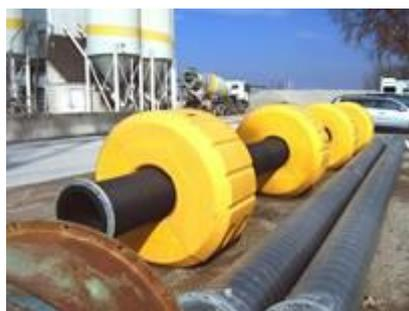
Abb. 5: Beispiel für eine Spüleleitung mit Schwimmkörpern.
