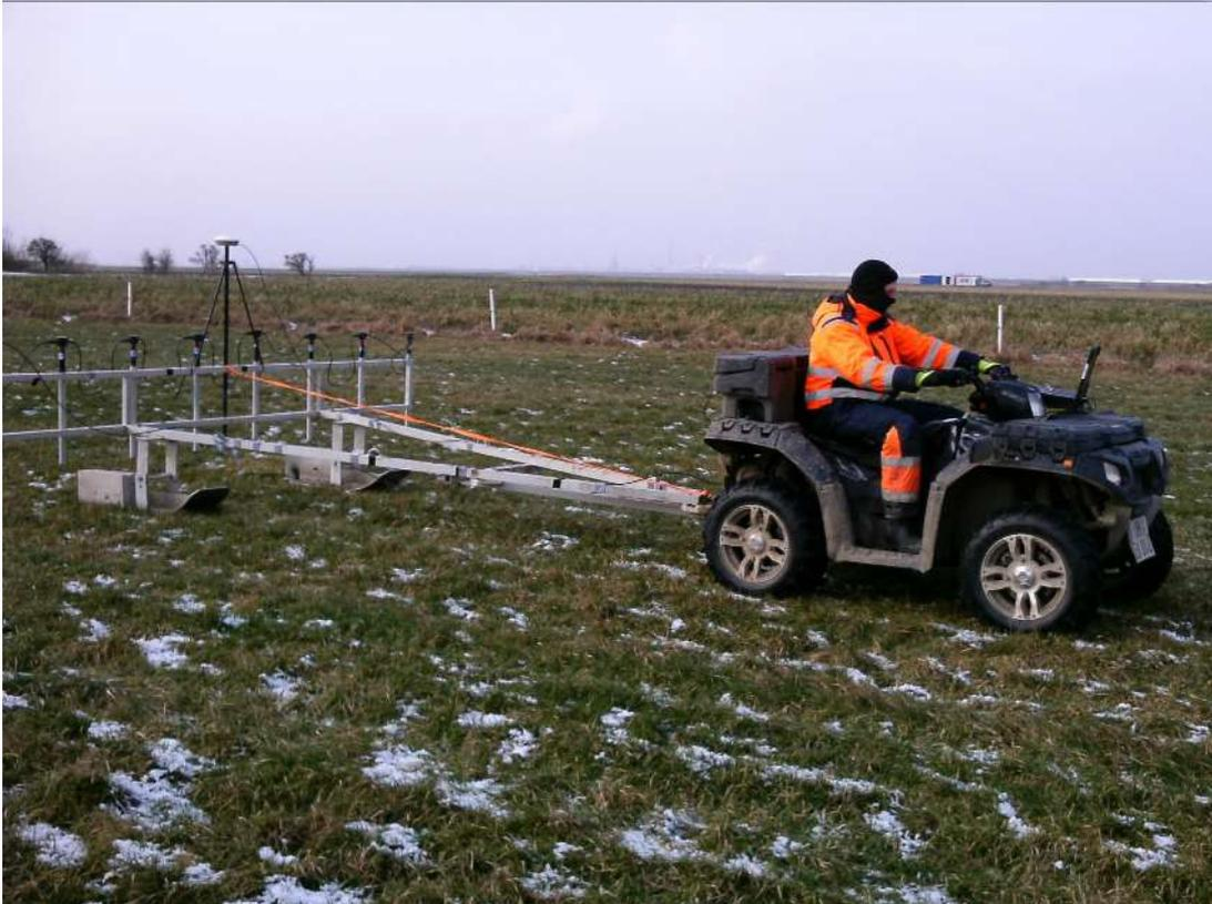
Foto 1: Mehrkanalsonde auf Schlitten, gezogen von Quad
