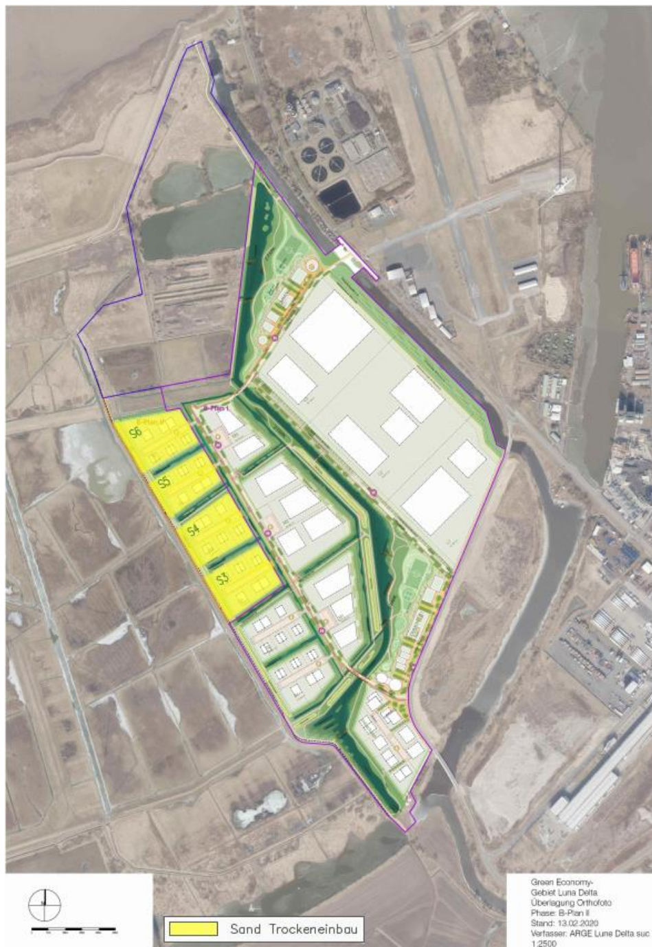
Abbildung 6- Warften und Einbaukonzept (Nass- und Trockeneinbau) für B-Plan II
