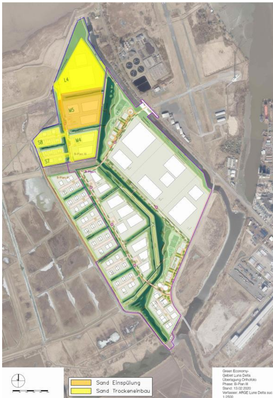
Abbildung 7 - Warften und Einbaukonzept (Nass- und Trockeneinbau) für B-Plan III
